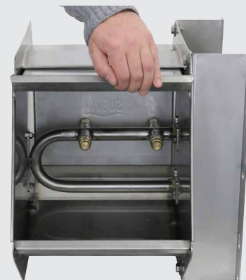
Pour le nettoyage, le capot de la soupape peut être ouvert sans outils
