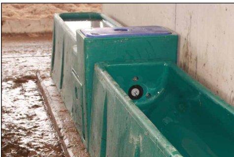
Bouchon obturateur pour le nettoyage en partie de l'abreuvoir quand l'autre est remplie d'eau.
